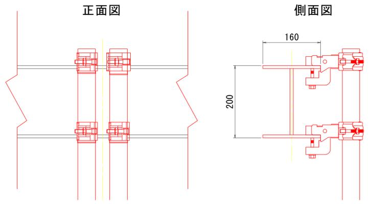
※対傾構下弦材も同様に単管と連結する
